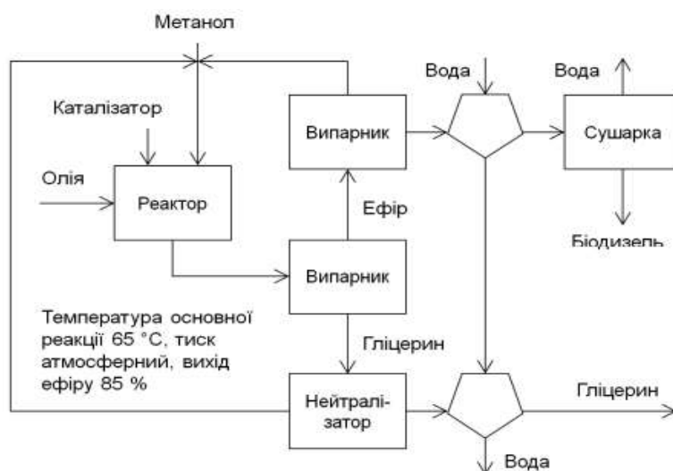
Рис. 3.3. Циклічна каталітична схема виробництва біодизельного палива [31]
