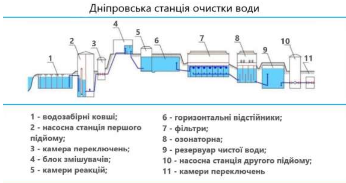
Рис. 4.1 Схема водоочистки на Дніпровській станції очистки води
