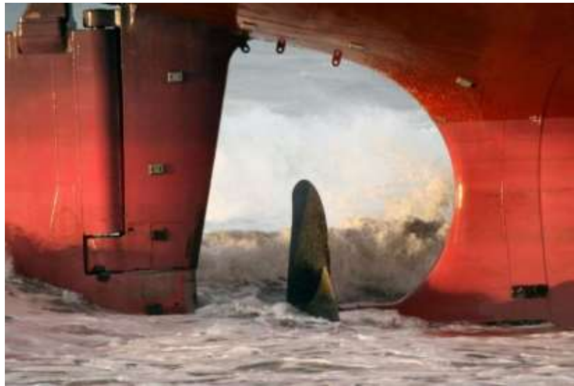
Рис.1.10. Розміщення протекторів на корпусі корабля
