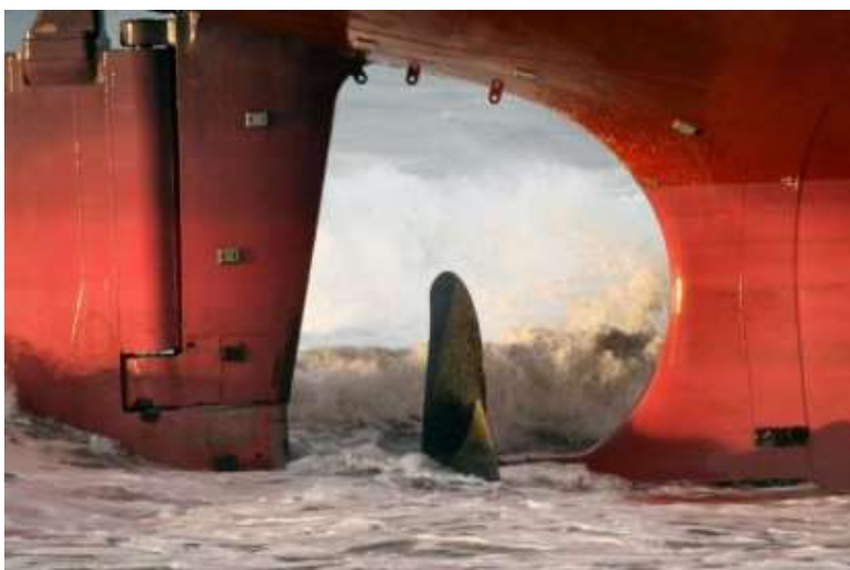
Рис.4.9.Розміщення протекторів на корпусі корабля
