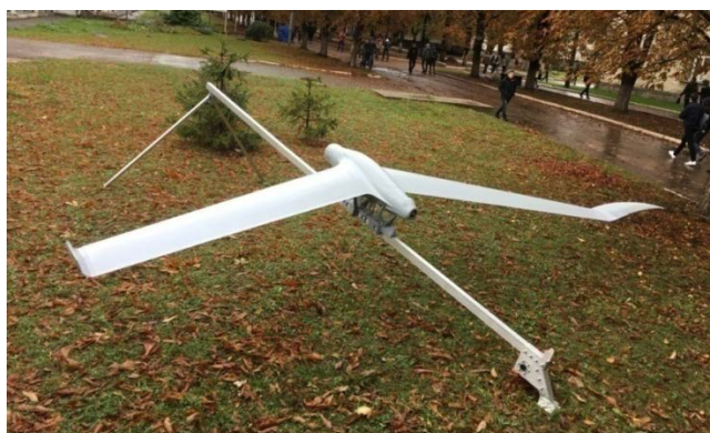
Fig. 4.27. General view of the UAVC M-56 «Module» in unfolded form (UAV M-56 «Module» on the launcher KP-6)
