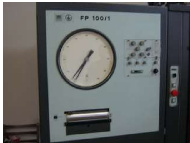
Рис.2.3.3 Загальний вигляд вимірювального та індикаційного пристрою пресової установки FP 100/1, що забезпечує зосереджене навантаження на зразок до 100кН.
