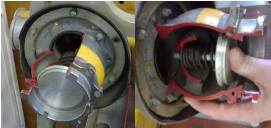
Рис.3.4. Розріз облачкового штуцера закритого заправлення ПЗ:
