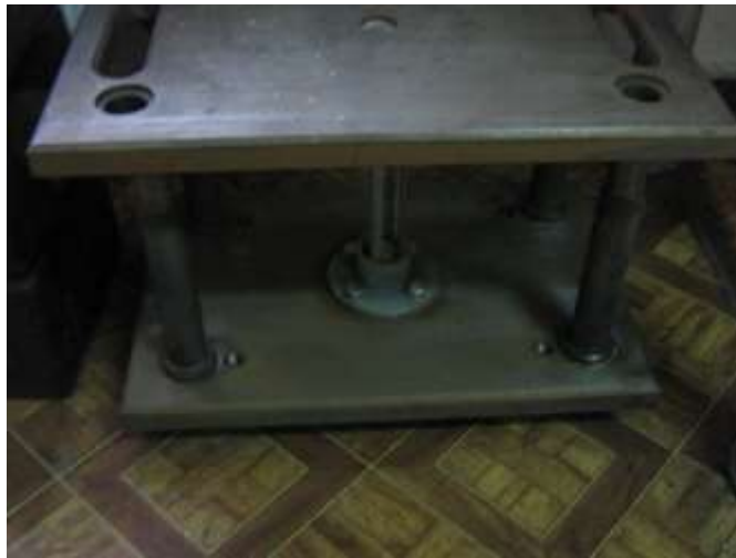
Рис.2.3.4 Станина пристрою пресової установки FP 100/1, що забезпечує зосереджене навантаження на зразок до 100кН.
