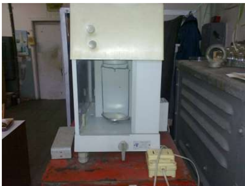
Рис.2.3.6 Аналітичні терези ВЛР-200 із точністю зважування 0,00005г:
