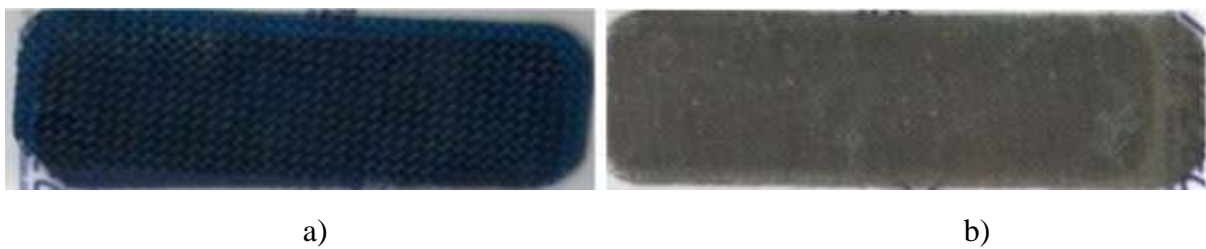
Рис.2.1.1. Зразки матеріалів для ущільнювачів: а – HI-TAK поліуретановий провідний ущільнювач зі стандартного антенного матеріалу; б – HI-TAK поліуретановий паливостійкий провідний ущільнювач (Патент США FG 323000-XX).
