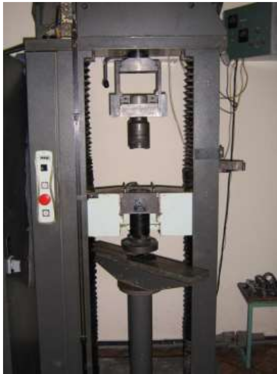
Рис.2.3.2 Загальний вигляд робочого вузла пресової установки FP 100/1, що забезпечує зосереджене навантаження на зразок до 100 кН.
