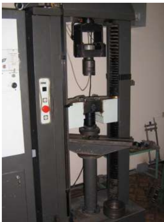
Рис.2.3.1 Загальний вигляд пресової установки FP 100/1, що забезпечує зосереджене навантаження на зразок до 100кН.
