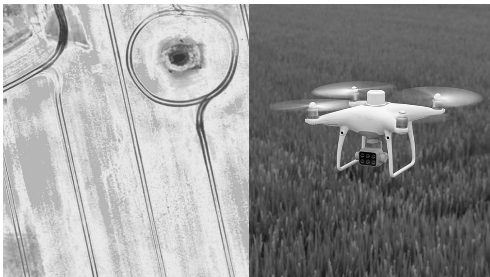
Рис 2.2 Приклад дрону [Dji phantom 4 multispectral] з мультиспектральною камерою та отриманої мапи.
