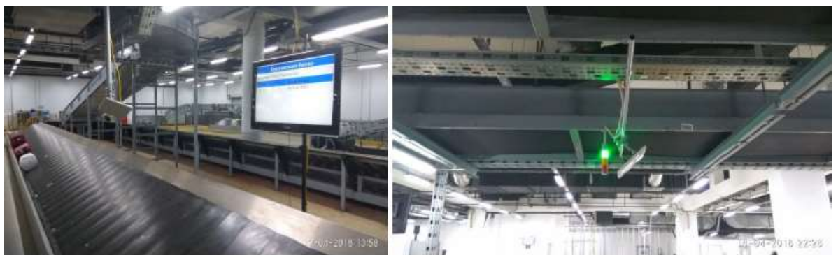
Рис. 3.10. RFID станція на каруселі комплектації
