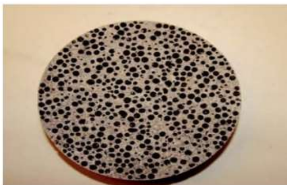
Рис. 3.2. Біобетон, що показує обсяг керамзито-лікувального засобу (50%). Бактеріальні спори та продукти живлення (темні частки) зберігаються від іммобілізації в окремих упаковках
