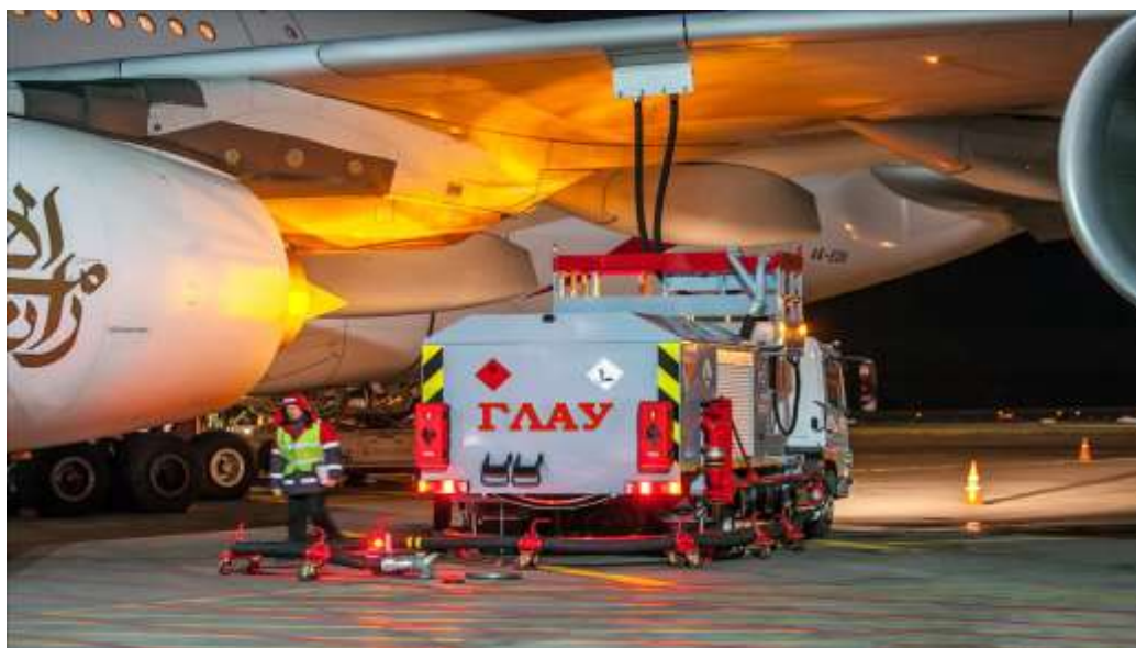
Рисунок 2.3 – Заправка повітряного судна спеціальними рідинами (мастила, рідини для гідросистем та ін.)
