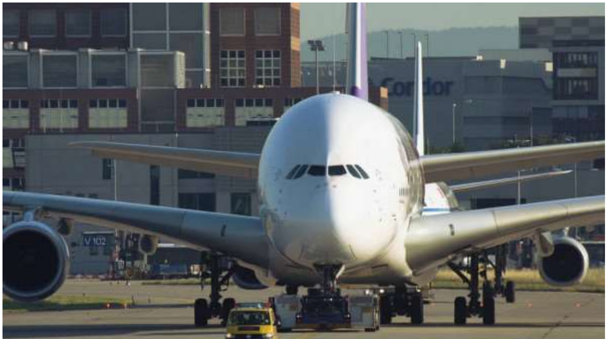
Рисунок 2.2 – Буксирування повітряного при обмеженості простору аеродрому
