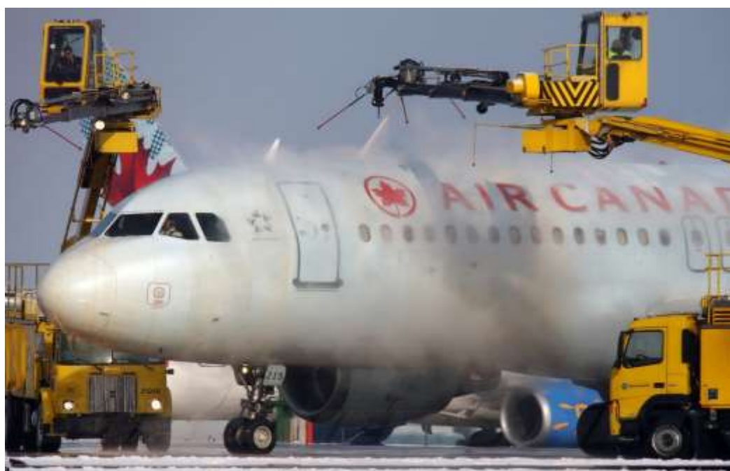
Рисунок 2.4 – Протиобмерзання повітряного судна перед вильотом
