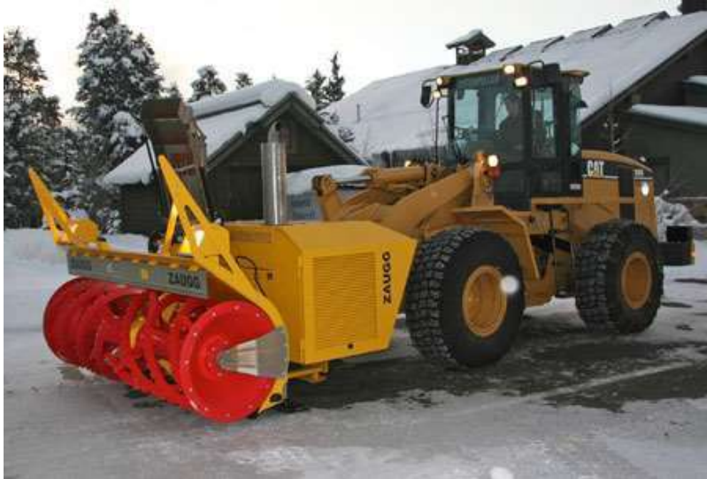
Рис. 1.9. Моноблок Мобі 170 ZAUGG з фрезерно-роторним робочим корпусом ZAUGG SF-90-85-R
