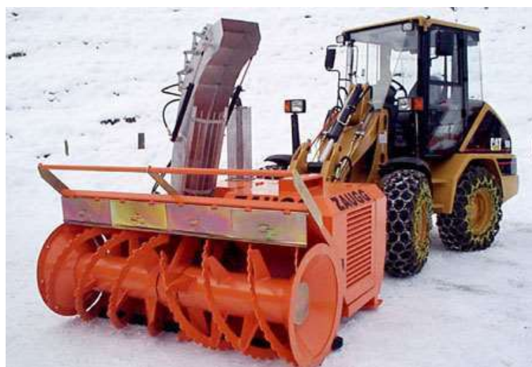
Рис.1.11. Моноблок МБ-73 ZAUGG з фрезерним і поворотним робочим корпусом ZAUGG SF-72
