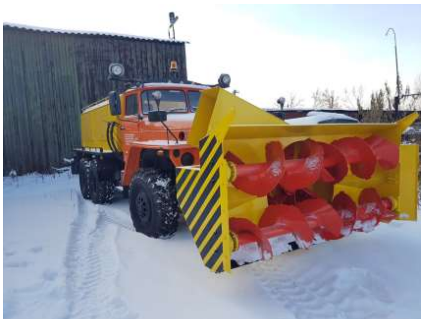
Рис. 1.12. Шнеко роторний снігоочисник КО-605М
