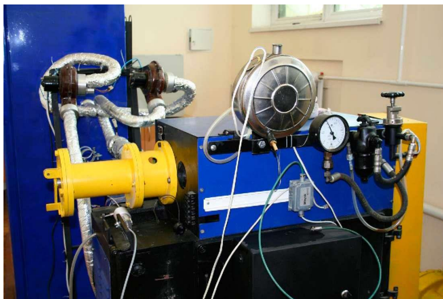
Рис. 2.5. Зовнішній вид модернізованої універсальної машина тертя СМТ-1.
