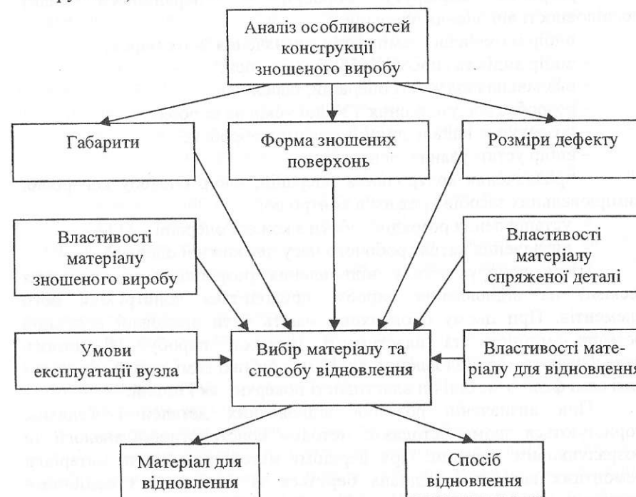
Рис. 1.2. Схема вибору матеріалу та способу відновлення
