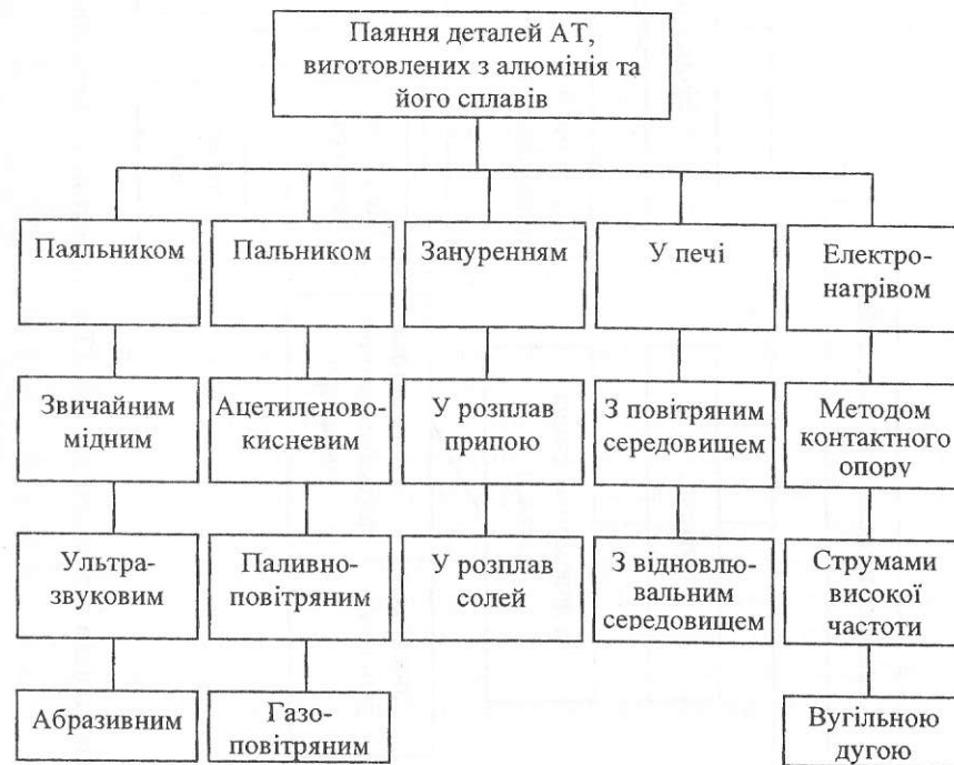
Рис. 7.4. Способи паяння деталей АТ, виготовлених з алюмінію та його сплавів
