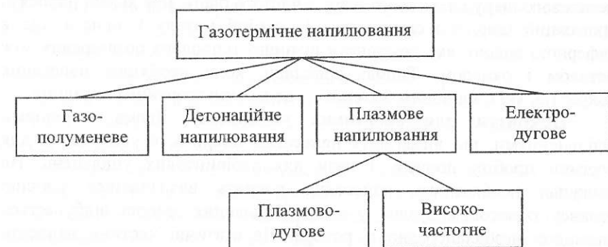
Рис. 3.3. Класифікація методів газотермічного напилювання за енергетичною ознакою
