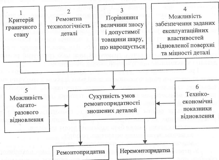
Рис. 1.3. Алгоритм проведення досліджень з оцінювання ремонтпридатності деталей, які відновлюються методами нарощування зношених поверхонь
