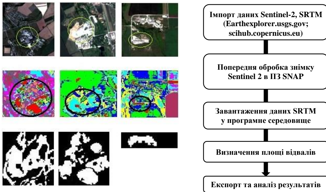
Рис. 3. Алгоритм визначення площі відвалів шахт
