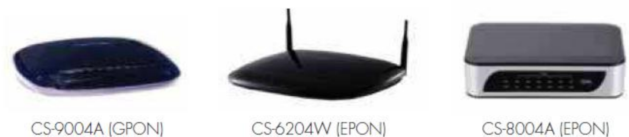
Рисунок 2.6. Обладнання настільних ONU CommScore.
