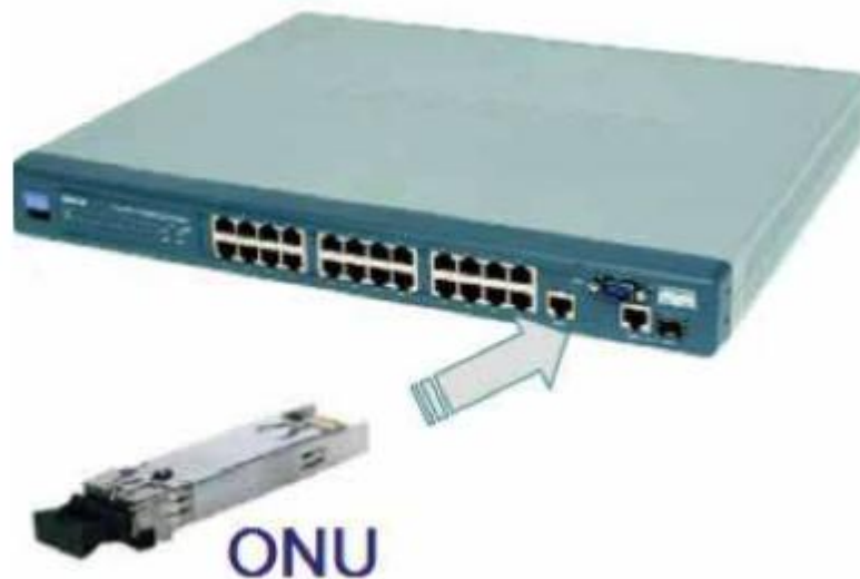
Рисунок 2.8. SFP ONU дозволяє операторам використовувати свої поточні комутатори Ethernet під час розгортання POL.
