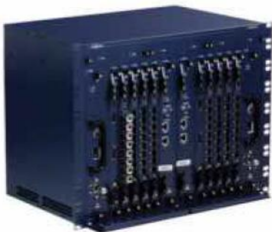
Рисунок 2.4. CommScore C9264 OLT — це багатофункціональний PON OLT високої щільності, великої ємності.
