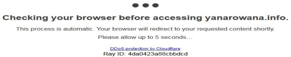
Рис. 3.16. Результат роботи режиму Under Attack Mode
