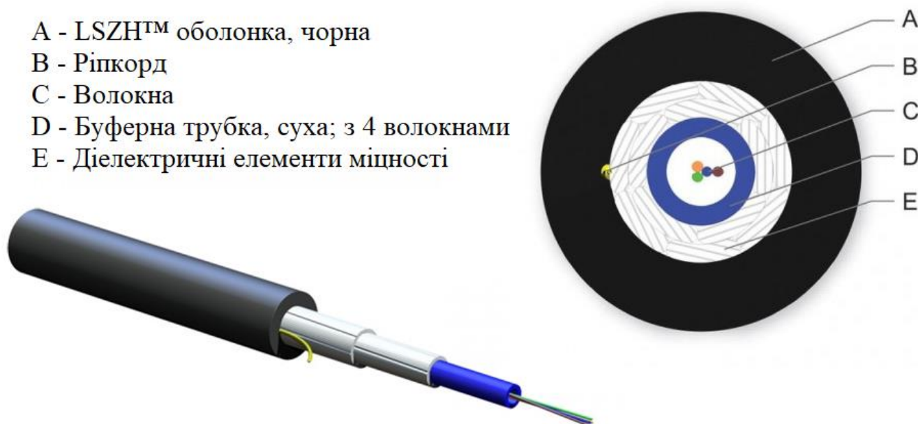
Рисунок 2.1. ВО універсальний кабель 1x4 E9/125 (SMF-28® Ultra)
