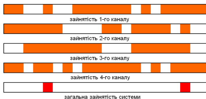
Рис. 1.1. Принцип транкінгу на прикладі 4-канальної системи
