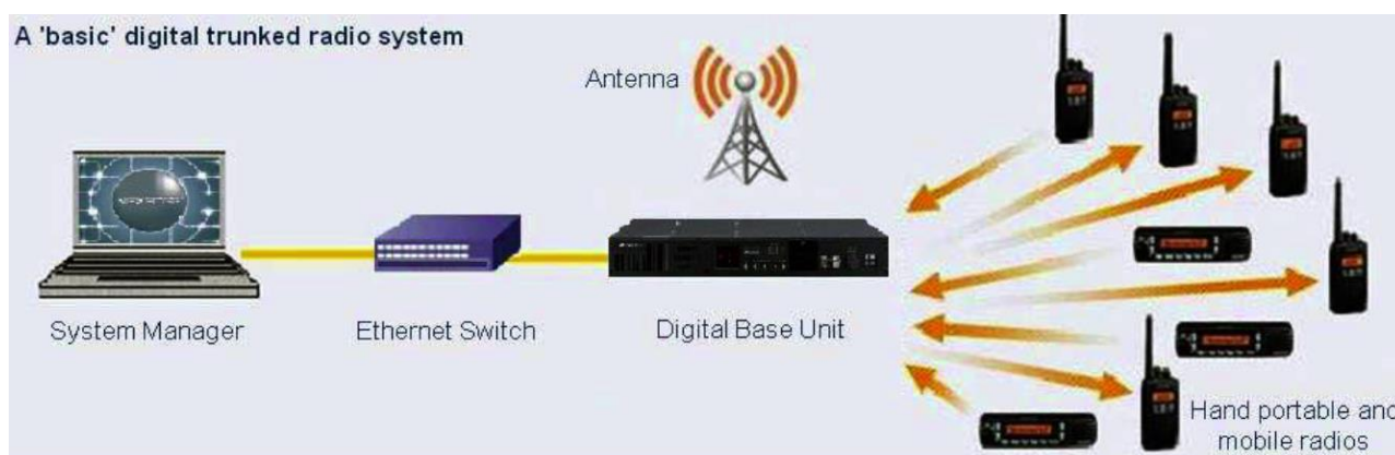
Рис. 1.2. Склад обладнання транкінгової системи радіозв'язку
