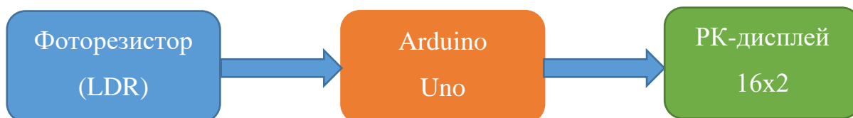
Рис. 3.6. Структурна схема приймальної частини передачі Li-Fi на основі плати Arduino
