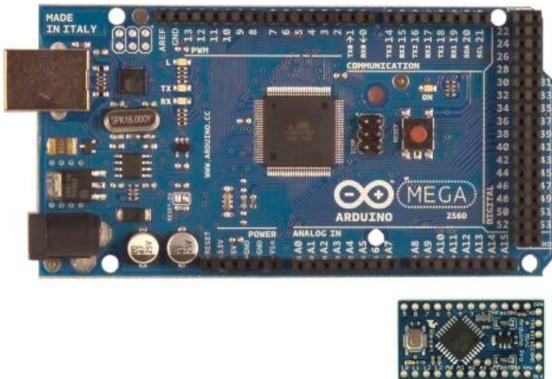
Рис. 3.3. Порівняння Arduino Mega і Arduino Pro Mini
