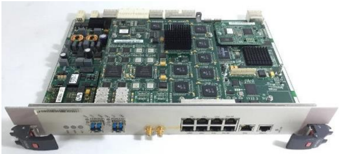
Рис. 3.2. Універсальний медіашлюз Huawei UMG8900
