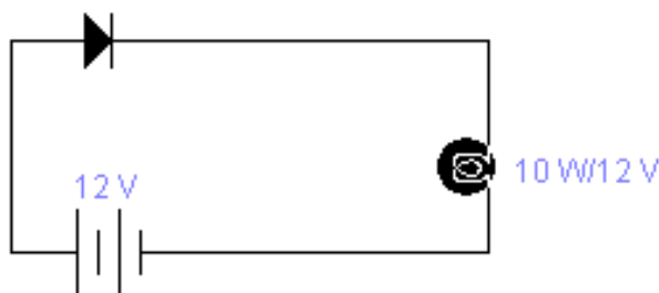
Рисунок 4.33 – Схема 2 з діодом та ввімкненою лампочкою
