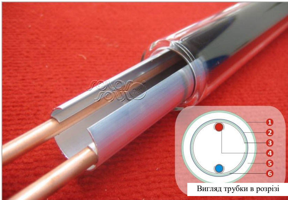
Рисунок 1.16 – Вакуумна коаксіальна трубка з прямоточним тепловим каналом; 1 – зовнішня скляна колба, 2 – високоселективне поглинаюче покриття, 3 – алюмінієва вставка, 4 – тепловий канал з теплоносій, 5 – вакуумний прошарок, 6 – внутрішня скляна колба
