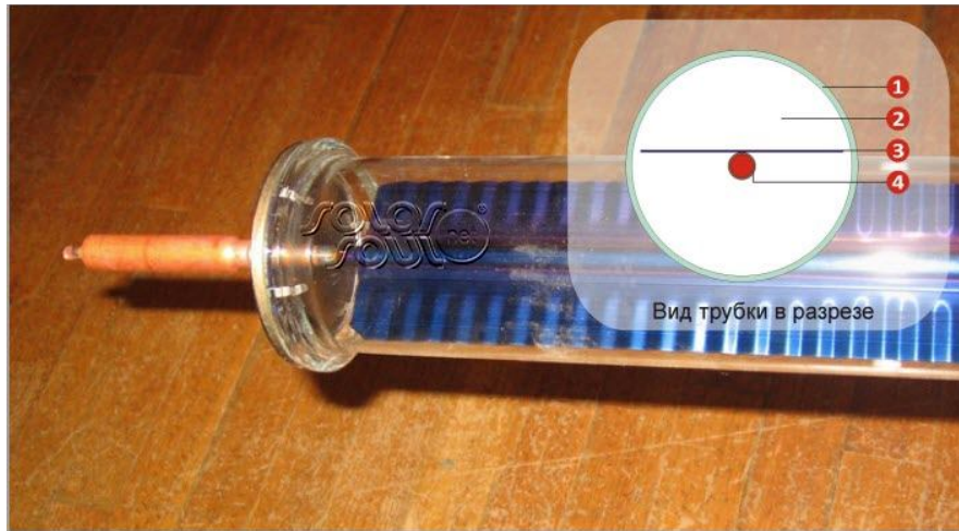
Рисунок 1.19 – Пір'яна трубка з тепловим каналом типу "Heat pipe": 1 – скляна колба, 2 – вакуумний прошарок, 3 – мідний абсорбер з високоселективним покриттям, 4 – тепловий канал з рідиною, яка легко випаровується
