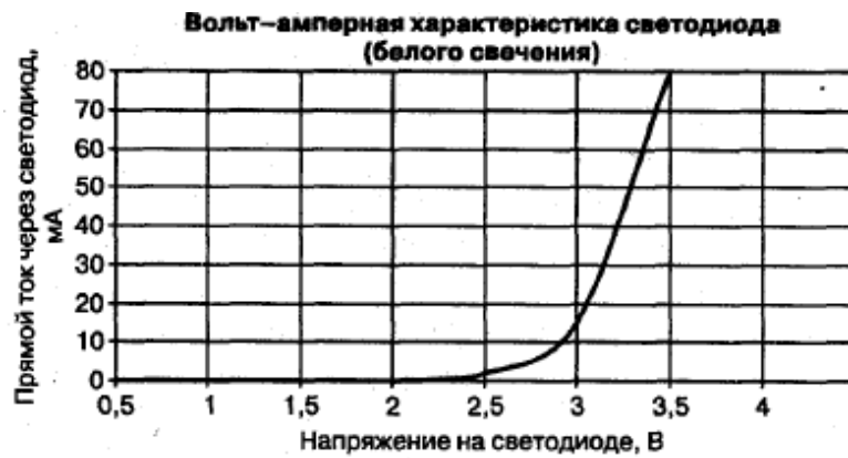
Рис. 1.3. Вольт-амперна характеристика світлодіода(білого світіння).
