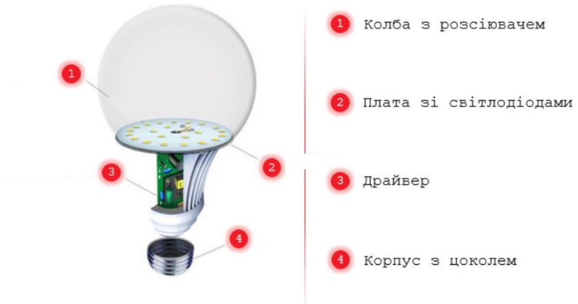
Рис. 1.3. Будова лампи з світлодіодними елементами
