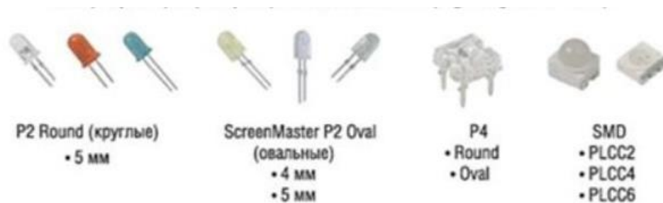
Рис. 1.2. Види світлодіодів на прикладі товарів фірми CREE.
