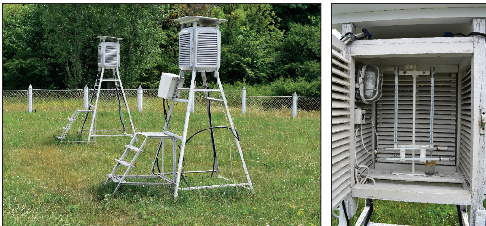
Рис. 2.5. Психрометричні будки для вимірів температури повітря та внутрішній вигляд однієї з них
