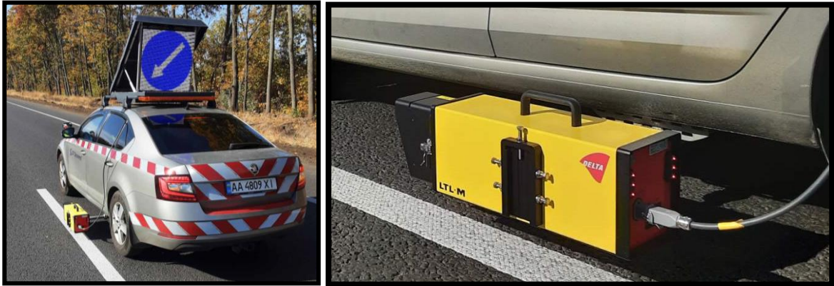
Рисунок 5.6. Сучасний прилад для здійснення контролю якості нанесення дорожньої розмітки
