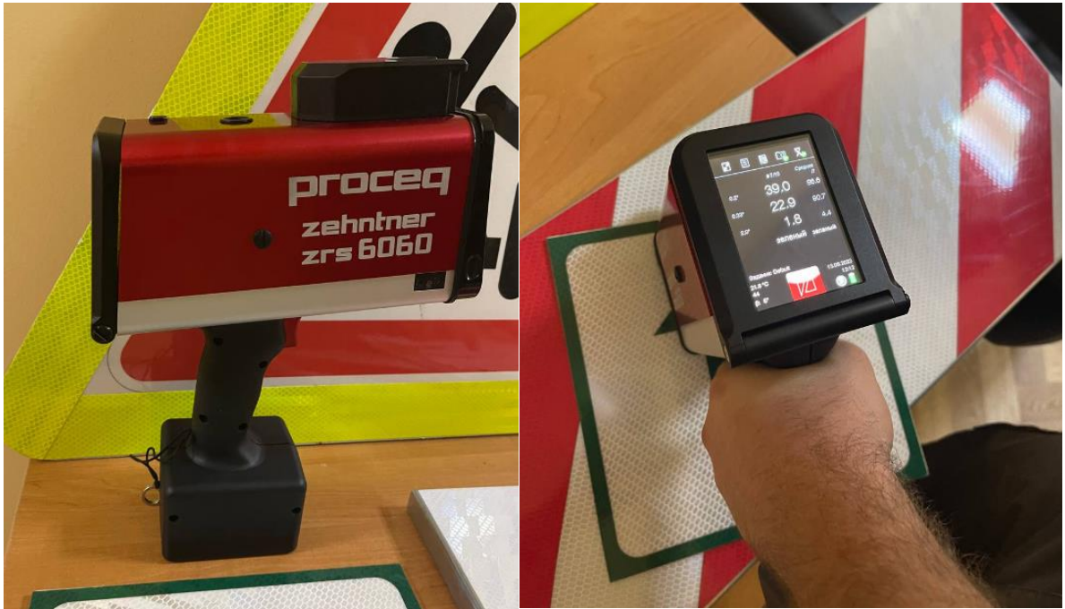
Рисунок 5.5. Прилад для вимірювання коефіцієнта світлоповертання Zehntner ZRS 6060
