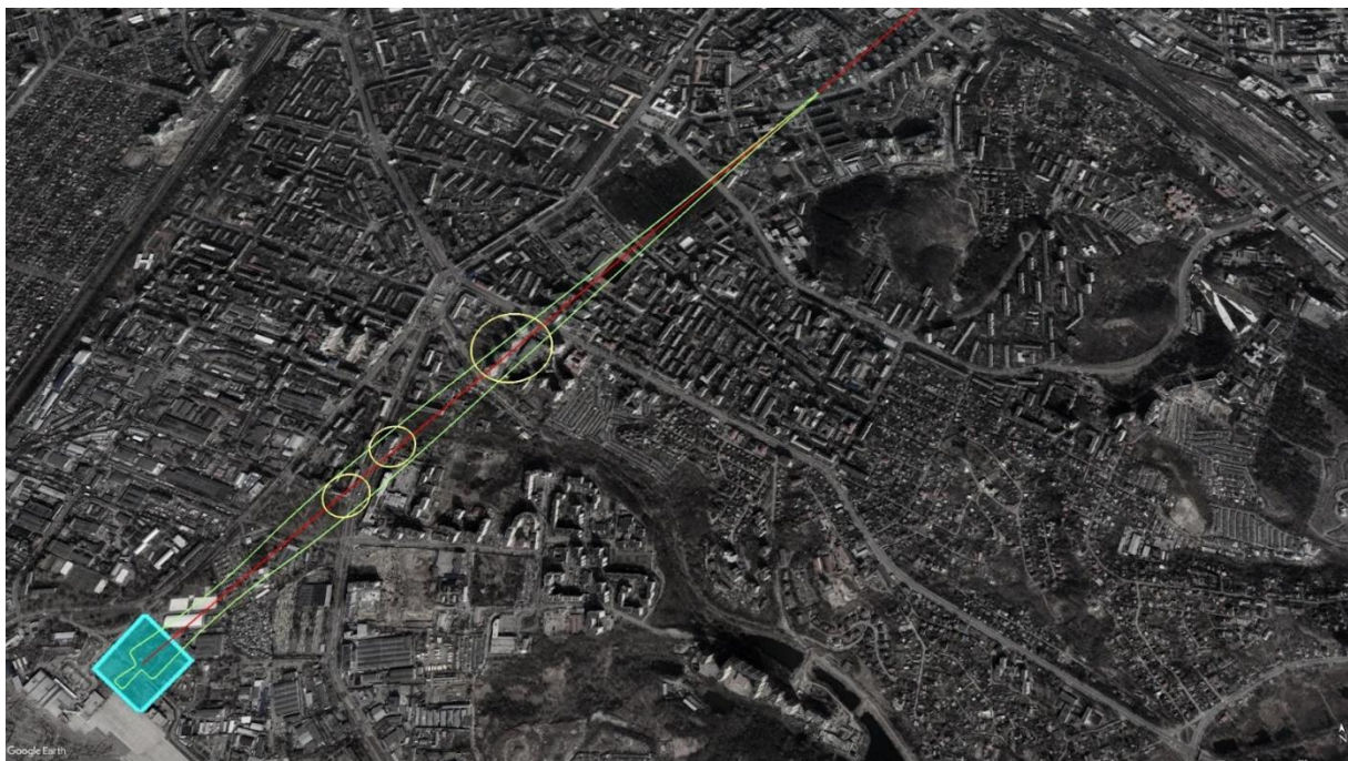
Рис. Є.1. Рівні ризику третьої сторони для Сценарію 1 поблизу Вертипорту 1: блакитний – територія вертипорту; червона пряма – прямолінійна траєкторія руху ПС UAM (Track 1), салатовий – контур рівного ризику 10^{-6} , жовті окружності – зони багатоповерхової забудови, що перетинають траєкторію руху ПС UAM.
