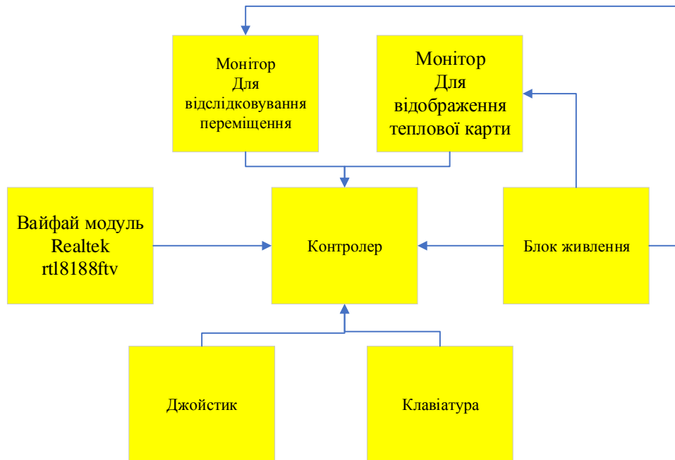
Рисунок 3.8 Структурна схема пульта керування
