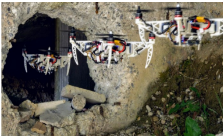
Рис. 3 – БпЛА, який може складатися і змінювати свої розміри під час польоту
