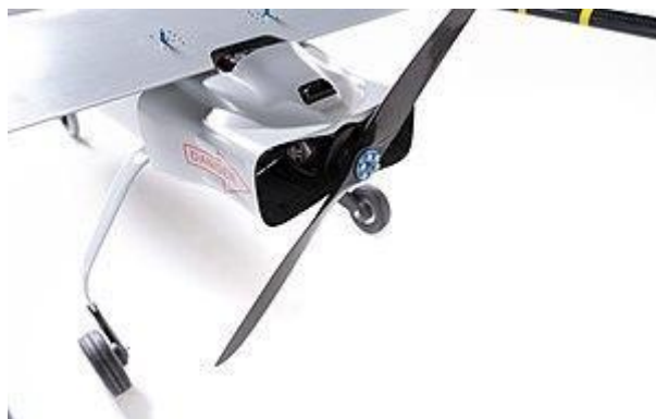
Рис. 25 Силова установка БПЛА оснащена карбоновим повітряним гвинтом
