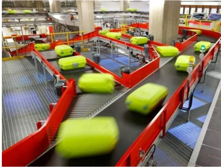
Рисунок 2.1 - Обробка багажу: MBHS, сортувальник високої пропускної здатності на основі технології поперечної стрічки
