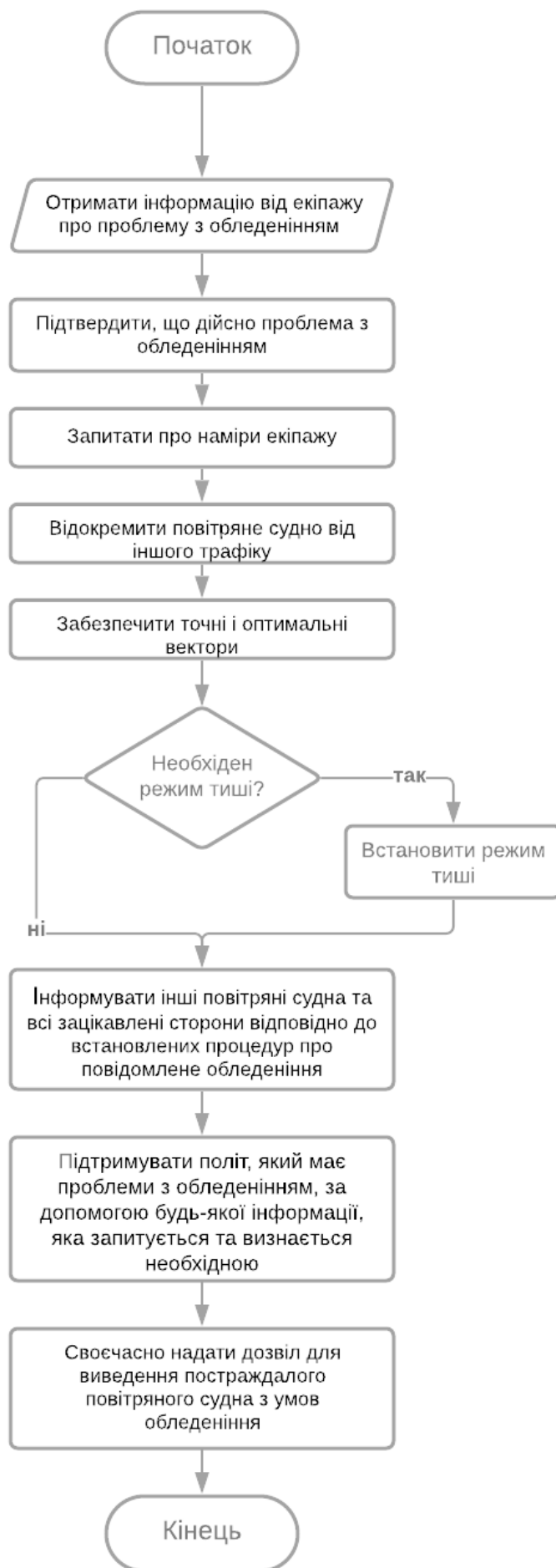
Рисунок 1.9 - Дії диспетчера при обледенінні ПС
