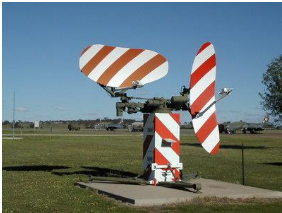
Рисунок 3.8. – Приклад PAR антен.[30]
