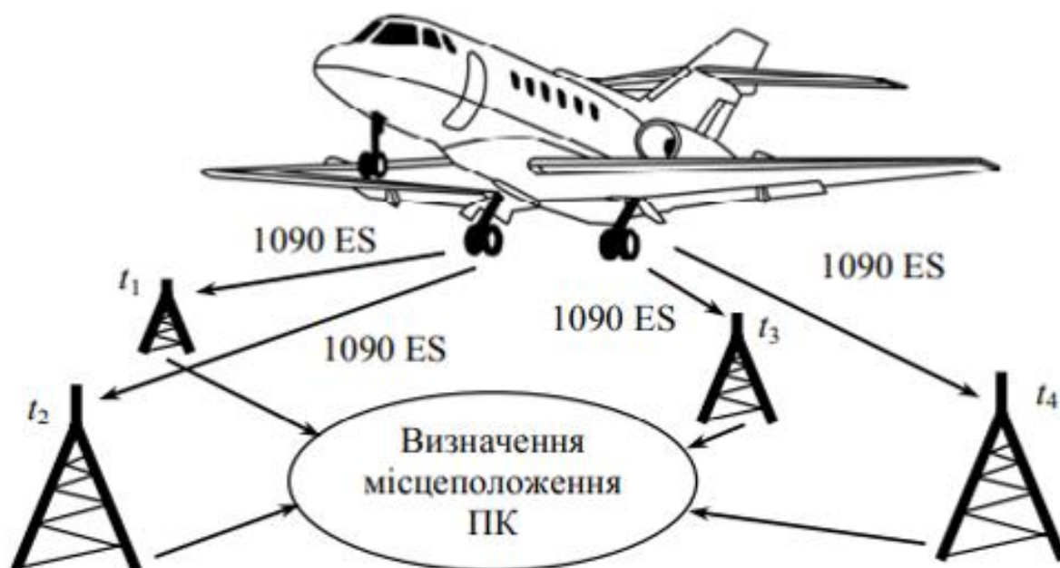
Рисунок 1.1. – Принцип функціонування MLAT[5]
