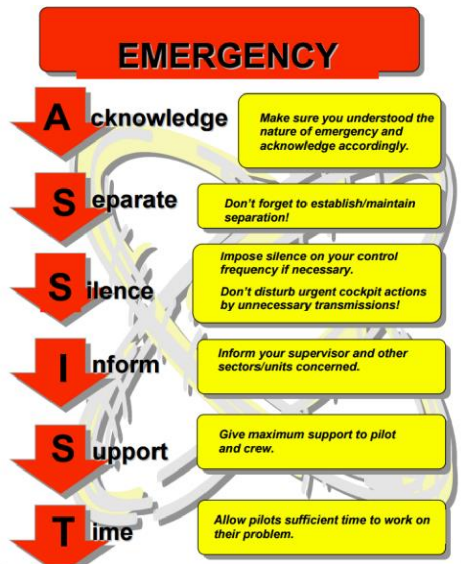
Рисунок 1.5 - Порядок дій авіадиспетчера під час аварійної ситуації згідно ASSIST
