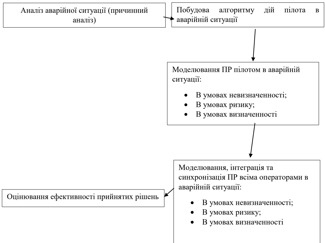
Рисунок 2.2 - Загальний алгоритм спільного прийняття рішень операторами в аварійній ситуації в польоті
