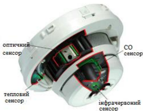
Рисунок 5.9 – Загальний вигляд комбінованого сповіщувача
