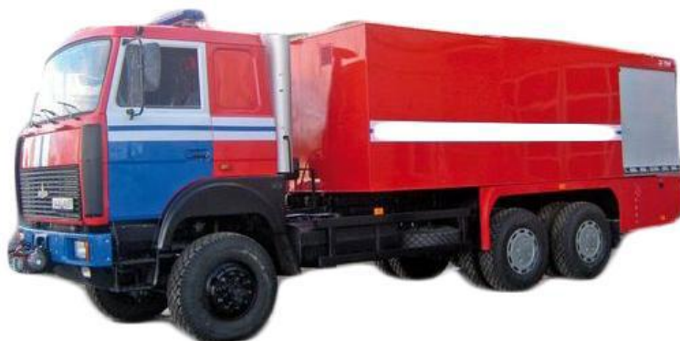
Рисунок 5.95 – Пожежна насосно-рукавна станція із запасом піноутворювача
