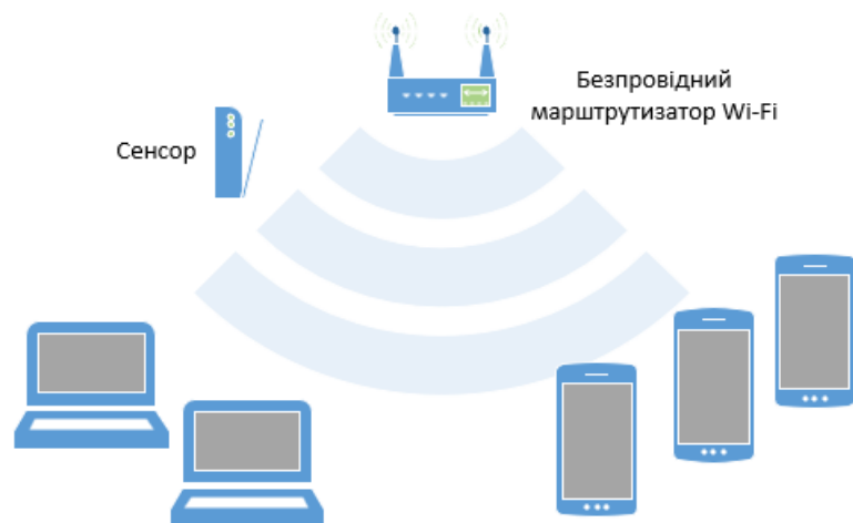
Рис. 3.24. Схема мережі, що використовується для навантажувального тестування
