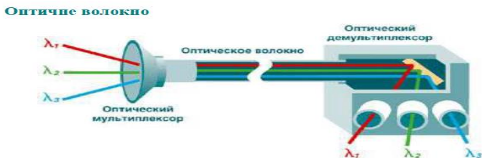
Рис.3.2. Фрагмент схеми передачі даних за допомогою DWDM
