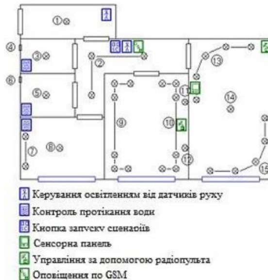
Рис. 1.7 Схема використання датчиків ГАЗу Води
