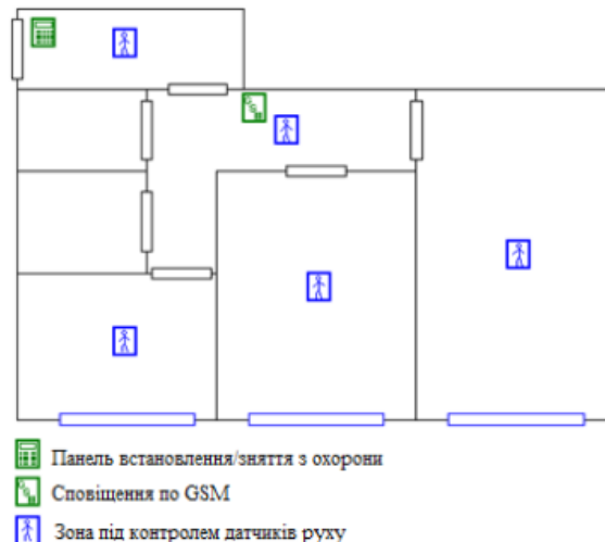
Рис. 1.6 Схема застосування датчиків охорони
