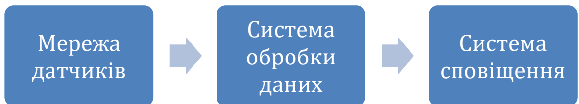
Рисунок 3.3 - Обов'язкові компоненти системи моніторингу стану критично важливих елементів інфраструктури
