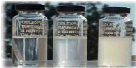
Рисунок 1.6 – Проби води з одиницями каламутності 5, 50 і 500 фармазіну.
