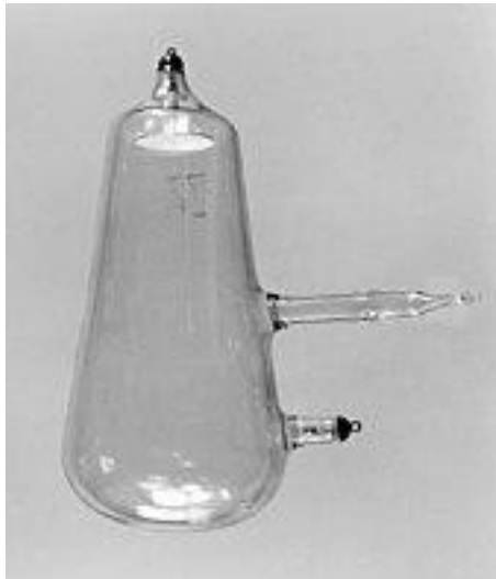
Рис 1. Приклад трубки Крукса, яка випромінювала рентгенівські промені
