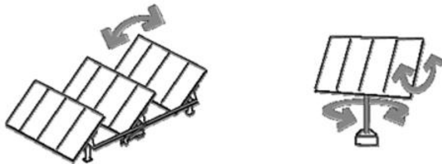
Рис.1.4. Одновісна і двовісна електромеханічна система сонячних батарей
