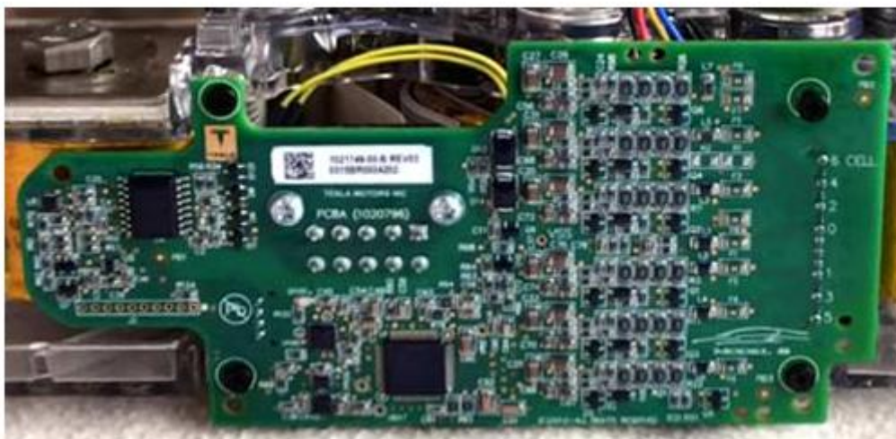
Рисунок 1.3-Плата BMS модуля
