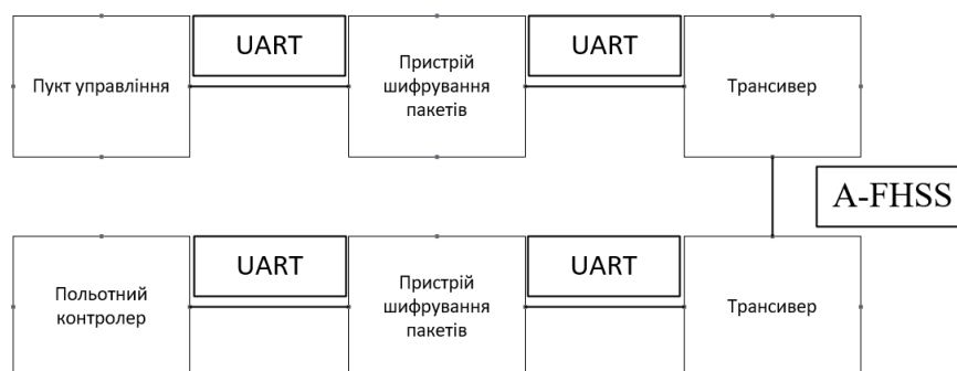
Рис.2.23. Спрощена схема блоків та між блочних протоколів тракт керуючого сигналу
