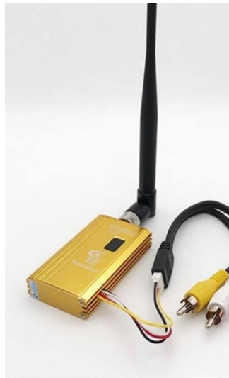
Рис.2.9. Типовий передатчик відео та аудіо сигналу на FPV підвищеної потужності
