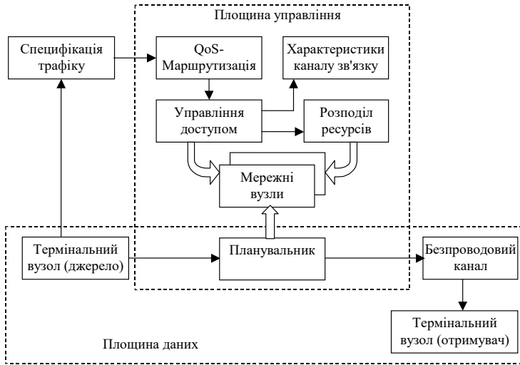
Рис. 1. Мережна архітектура для резервування QoS .
