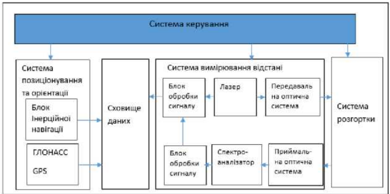
Рис. 2.11. Структурна схема системи LIDAR
