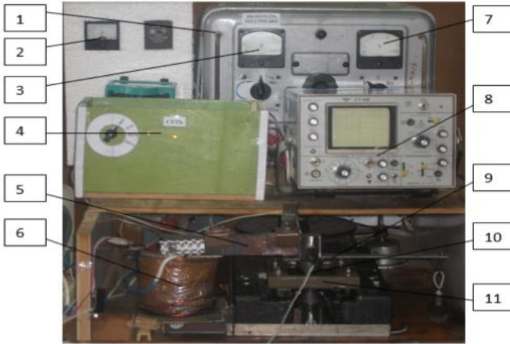
Рис. 1. Установка для дослідження матеріалів на тертя та зношування при реверсивному переміщенні: 1 – незалежне джерело живлення для створення магнітного поля в зоні тертя, 2 - амперметр для реєстрації магнітного поля, 3 - амперметр для реєстрації струму в зоні тертя, 4 - переривник, 5 - магнітопровід, 6 - котушка індуктивності, 7 - джерело живлення, 8 - осцилограф для реєстрації параметрів електричного струму в магнітопроводі, 9-навантаження, 10 – вузол тертя, 11 - ємність для робочого середовища.
