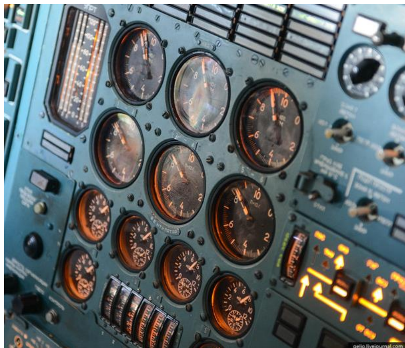
Рис. 3.4. Індикатори роботи двигунів Ан-225 Мрія
