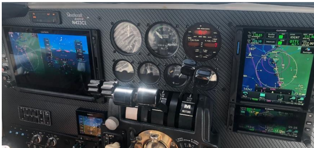
Рис. 1.2. Приладова дошка літака Beechcraft Baron с оновленою авіонікою Garmin
