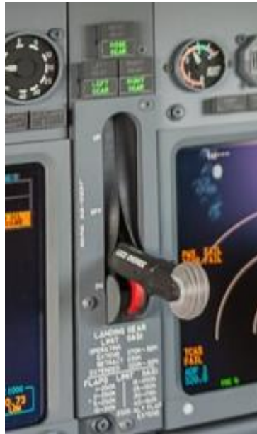
Рис. 3.9. Управління системою шасі
