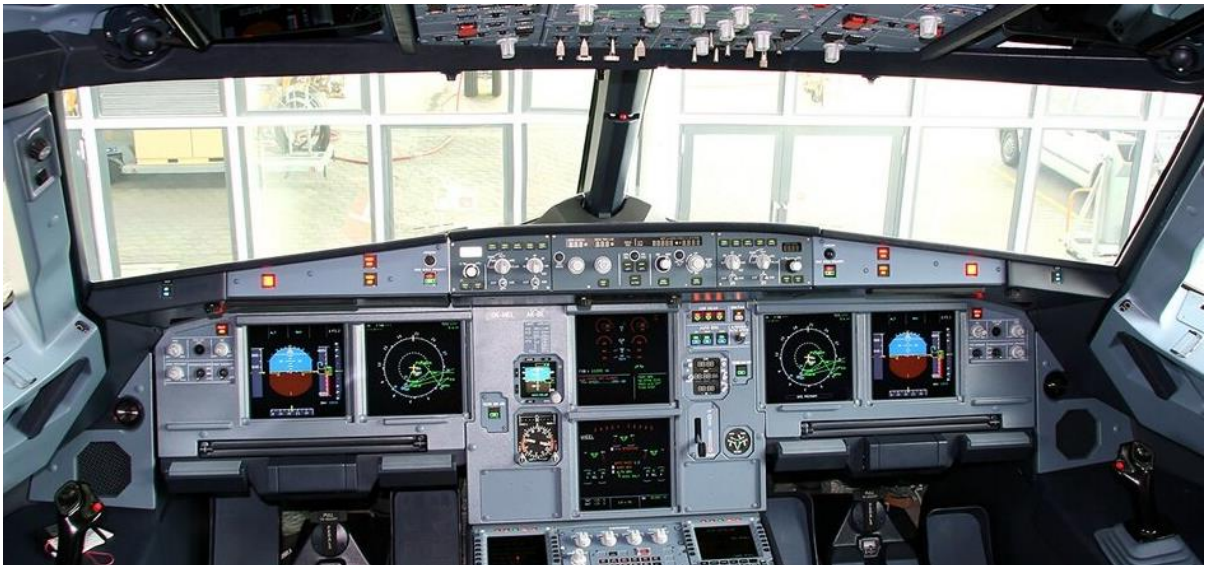
Рис. 1.3. “Скляна кабіна” літака Airbus A320
