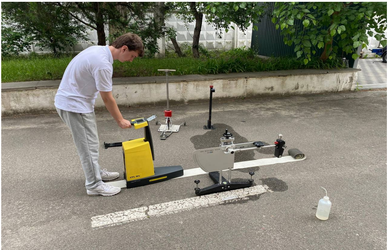
Рисунок 5.1 Проведення експерименту за допомогою ретрорефлектометра дорожньої розмітки DELTA LTL – XL.
