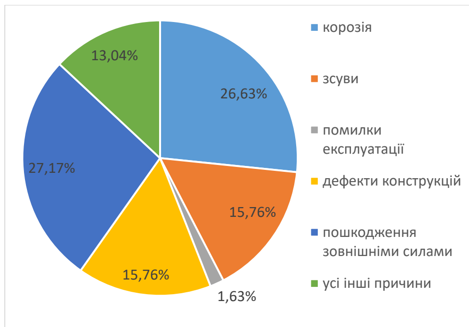
Рис 2.9. Розподіл аварій на газопроводах Європи за причинами
