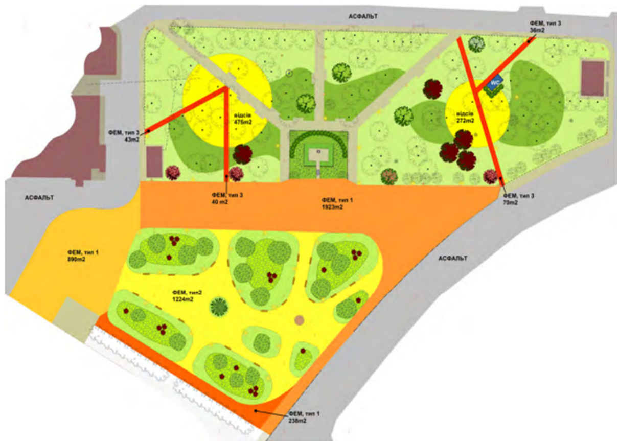
Рис.2.7. Приклад плану-схеми покриттів для центральної площі із зеленою зоною в м. Хоростків, Хоростківська ТГ, Тернопільська область Примітка: джерело [17]
