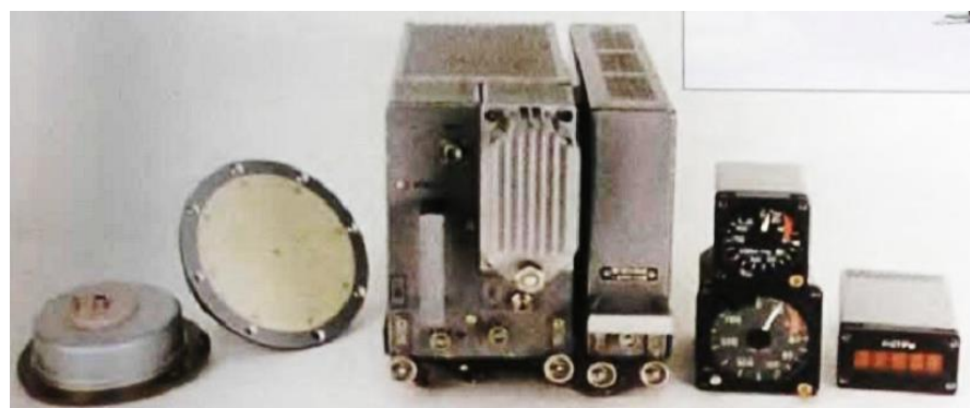
Рис. 3.10.б. Імпульсний радіовисотомір А-075
